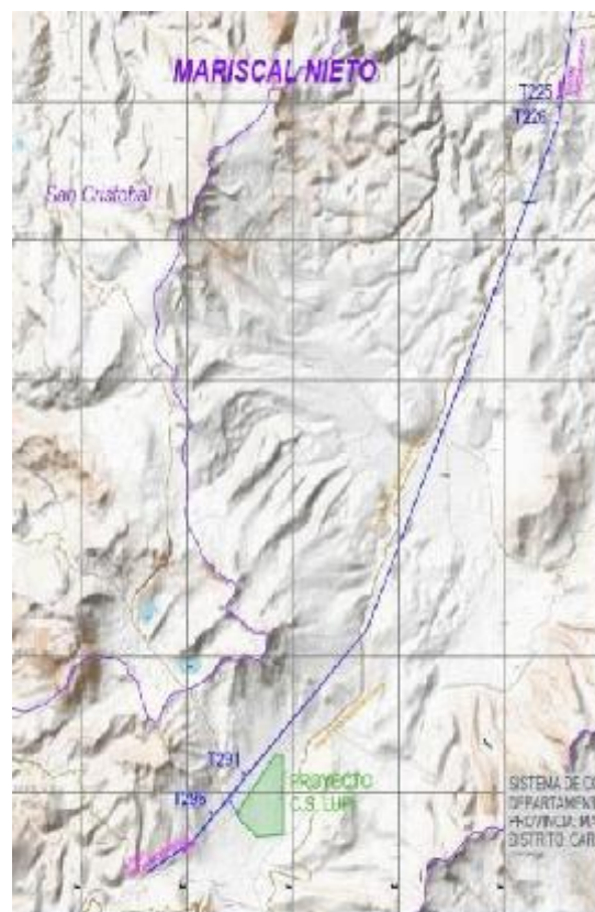
Figura N° 47 TRAZO DE RUTA DE LINEAS DE 220Kv
