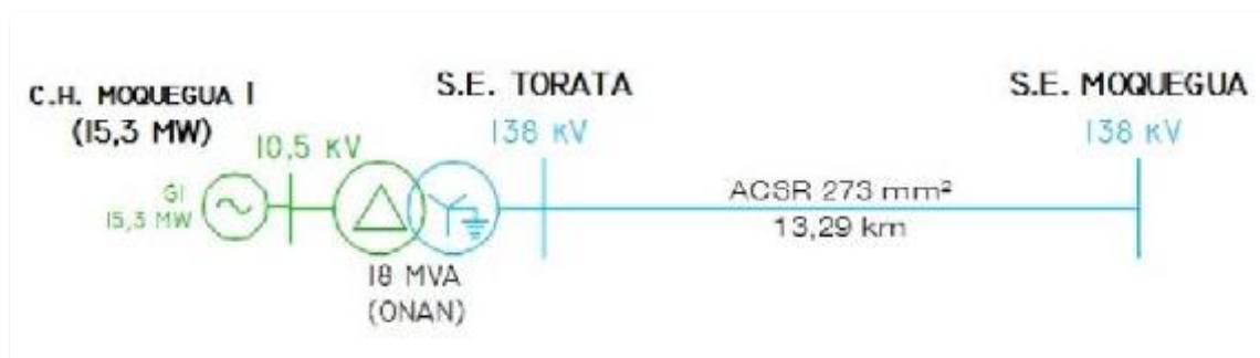
Figura N°39 Diagrama Unifilar Central Hidroeléctrica Moquegua 1
